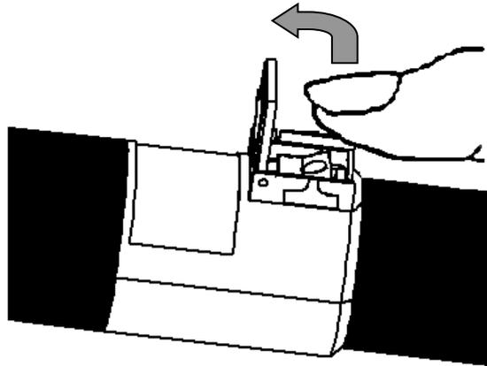
②作動スイッチの斜面部を手前に引くように押してください。
