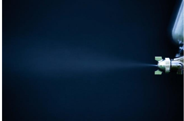
写真2 スプレーガンによる 《クリアフリーズ™》の噴霧
